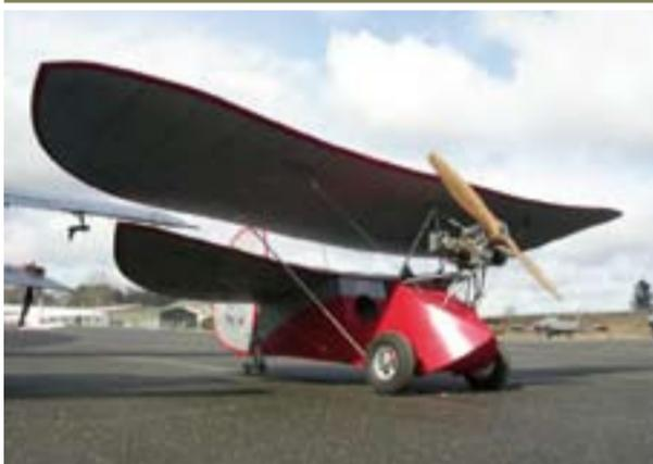
verrière est en Plexiglas moulé à armature en stratifié verre-résine. Le fuselage est en tube d'acier soudé, le revêtement entoilé, la cabine en stratifié de polyester. L'aile est en bois et contreplaqué, entoilée. Le dispositif d'atterrissage est composé d'une roue précédée d'un patin avant bois, et d'un patin arrière métallique.
